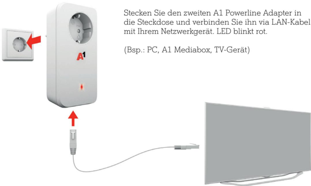
Stecken Sie den zweiten A1 Powerline Adapter in die Steckdose und verbinden Sie ihn via LAN-Kabel mit Ihrem Netzwerkgerät. LED blinkt rot.
