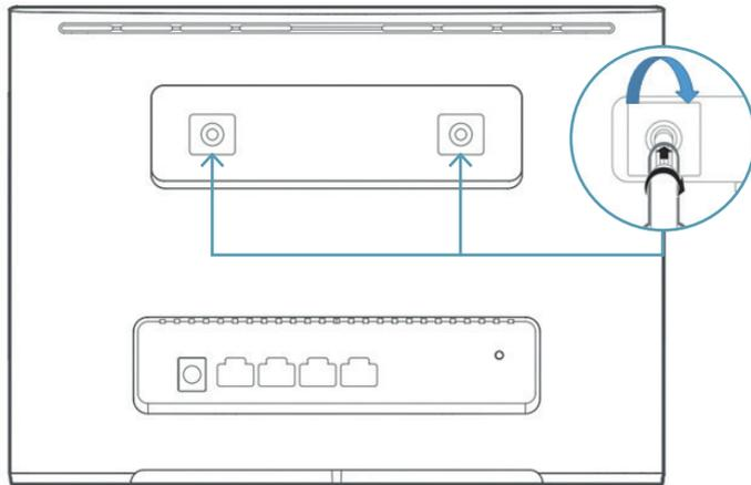
**Optional:** Bei Bedarf erleichtert der beige packte Schraubenschlüssel die Befestigung des Antennenkabels am Modem
