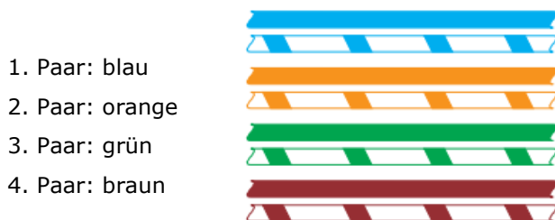
Abbildung 4: Farbencode und Zählweise eines Netzwerk-Kabels (EIA/TIA-568B)
